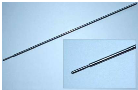
ภาพที่ 4 The stainless steel probe ขนาดความยาว 27 ซม. เส้นผ่านศูนย์กลาง 3 มม. ที่มีปลายเล็ก ความยาว 3 ซม. เส้นผ่านศูนย์กลาง 2 มม. (ภาพจาก Binnebösel M, et al. Endoscopy. 2010;42:E17-E18)
